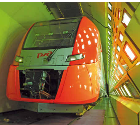
Im Klima-Wind-Kanal lässt sich die Qualität der Fahrzeuge bei jedem Wetter testen.
